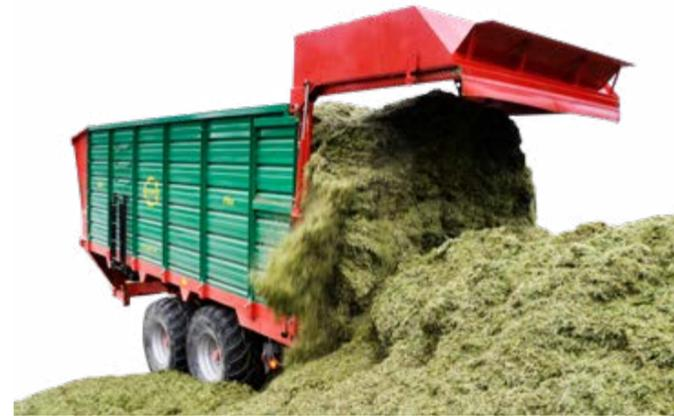
Apertura de la puerta hidráulica trasera totalmente sincronizada con el accionamiento del sistema de arrastre.
