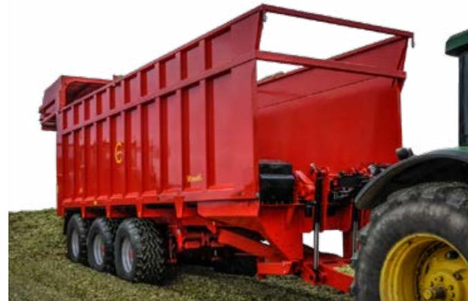
Combinación del piso del remolque junto al frontal móvil. Apertura de la puerta hidráulica trasera totalmente sincronizada con el accionamiento del sistema de arrastre con piso de banda móvil de PVC comandada por un electrodistribuidor hidráulico.
