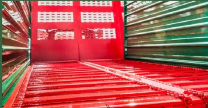
Equipado con un sistema de arrastre por cadenas. Tensores independientes manuales.
