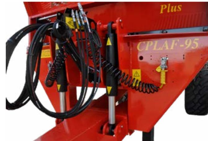
Doble acumulador de baja y alta presión para la suspensión de la lanza y de los ejes. Lanza con elevación hidráulica accionada desde el mando del tractor y descenso hidráulico con sistema de suspensión hidráulico variable en altura que proporciona una mayor estabilidad al remolque y con doble pie de apoyo mecánico.
