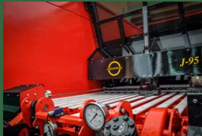
Equipado con un sistema de arrastre con piso con banda móvil de PVC, fondo autodeslizante por guías de polietileno de alta densidad.
