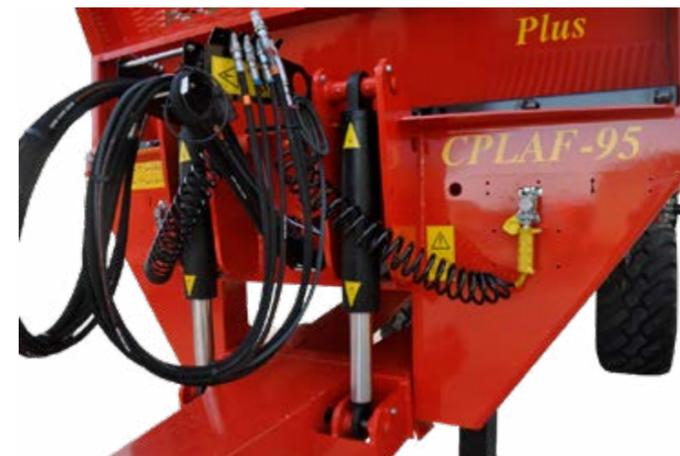
Doble acumulador de baja y alta presión para la suspensión de la lanza y de los ejes.
