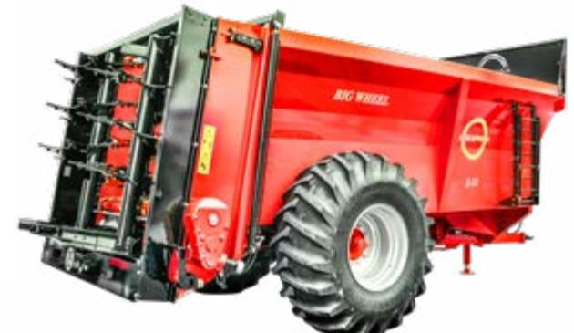
Tapa trasera apertura vertical tipo guillotina con sistema de compensación de cilindros.
