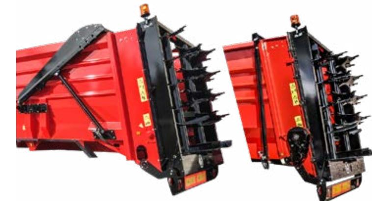
Tapa trasera hidráulica para la protección de los molinetes.
