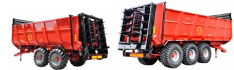
Tapa trasera hidráulica para la protección de los molinetes.
