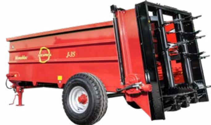
Lanza fija regulable en altura de serie o lanza móvil con cilindro hidráulico opcional.
