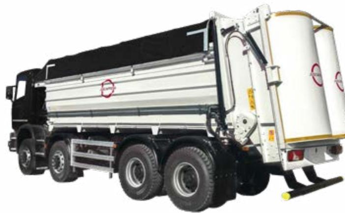
Tapa trasera hidráulica para la protección de los molinetes.
