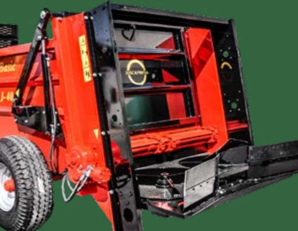
Doble molinete horizontal con púas planas atornilladas y con 2 platos inferiores.
