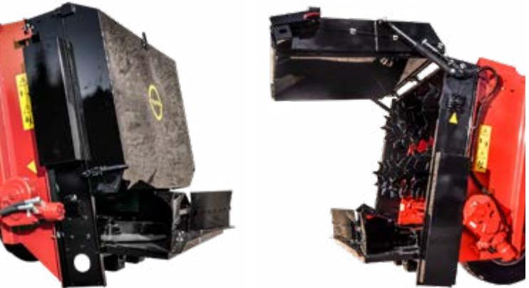
Puerta trasera hidráulica con apertura tipo compás guiada con banda sintética para el cierre de la tapa trasera hidráulica; tapa localizadora del estiércol fija desmontable de serie o tapa localizadora del estiércol con apertura hidráulica en opción.
