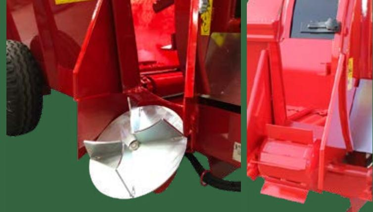
Sistema espardor con descarga hidráulica lateral mediante plato de serie en los modelos E35CCVLG1, E35CVLG1, E35LVLG1 y E40LVLG1 u opcional en los modelos E50LVLG1.
