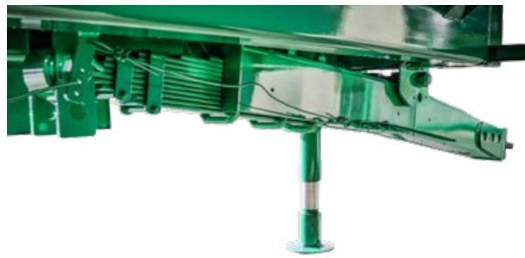
Eje suspensión bogie autodireccional en segundo eje cuadrado 150mm, vía 2000, 10 esp., tambor freno 400x120.
