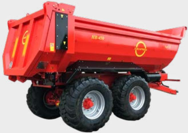
Lanza con ballestas 13 hojas con pie hidráulico con bomba manual.
