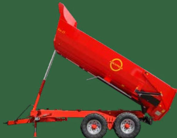
Caja basculante cilíndrica de gran resistencia, diseñada con gran cantidad de pliegues que consiguen una gran rigidez de la misma y a la vez que aligeran su peso. Conformación redondeada de la caja que disminuye considerablemente la adherencia de la carga: su contorno actúa como tobogán dirigiéndola al centro durante la descarga.
